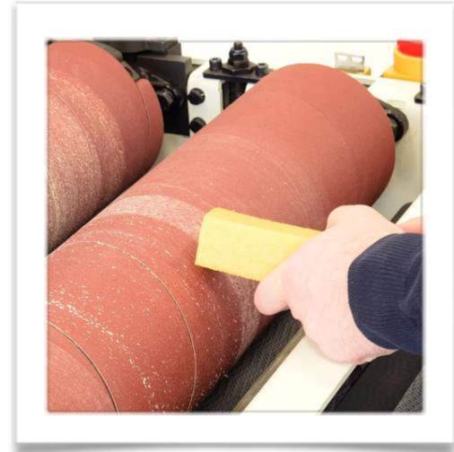
Ein idealer Helfer, um die Lebensdauer von Schleifpapier zu verlängern. Nach dem Schleifen können Sie auf dem Schleifband zurückgebliebenen Schleifstaub leicht entfernen, sodass Sie das Schleifleinen oder -papier wieder verwenden können.
