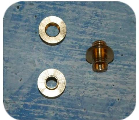
Die Musterstücke wurden mit einem 10,72mm Bohrer gebohrt, die beiden Gewindeteile wurden danach mit einem Epoxid-Kleber eingeklebt.
