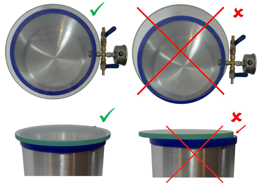
Foto Nr. 20: Richtige (links) und falsche (rechts) Positionierung des Deckels auf der Vakuumkammer.
