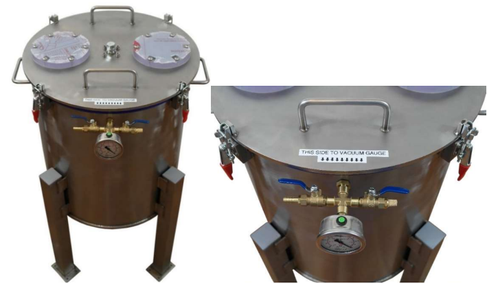
Foto Nr. 14: Richtige Position des Deckels auf der Vakuunkammer.
