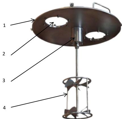
Foto Nr. 13: Rührwerk am Deckel montiert.
