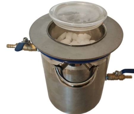
Foto Nr. 18: Vakuum-Kühlfalle mit Trockeneis gefüllt.
