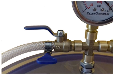
Foto Nr. 8: Pneumatischer Schlauch am Kugelhahnstutzen, gesichert mit einer Schneckenklemme.
