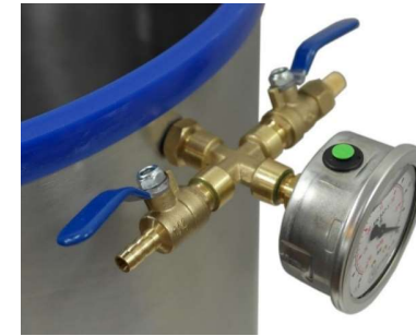
Foto Nr. 6: Ventilsinsel korrekt montiert.
