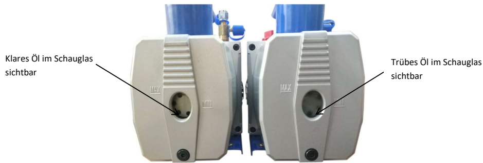
Foto Nr. 19: Effektivität der Vakuum-Kühlfalle – Sauberkeit des Öls in den Vakuumpumpen (links: klares Öl bei Verwendung einer Vakuum-Kühlfalle, rechts: trübes Öl, wenn keine Vakuum-Kühlfalle verwendet wird).
