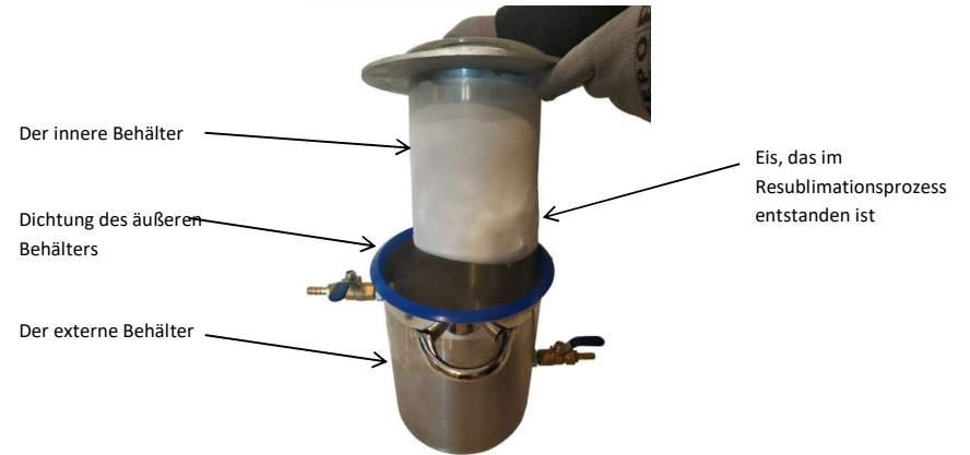
Foto Nr. 17: Interner und externer Behälter und das gefrorene Material, das auf dem inneren Behälter gesammelt wurde.
