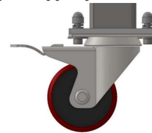
Zeichnung Nr. 1: Richtige Montage des Rades zum Behälterbein.
